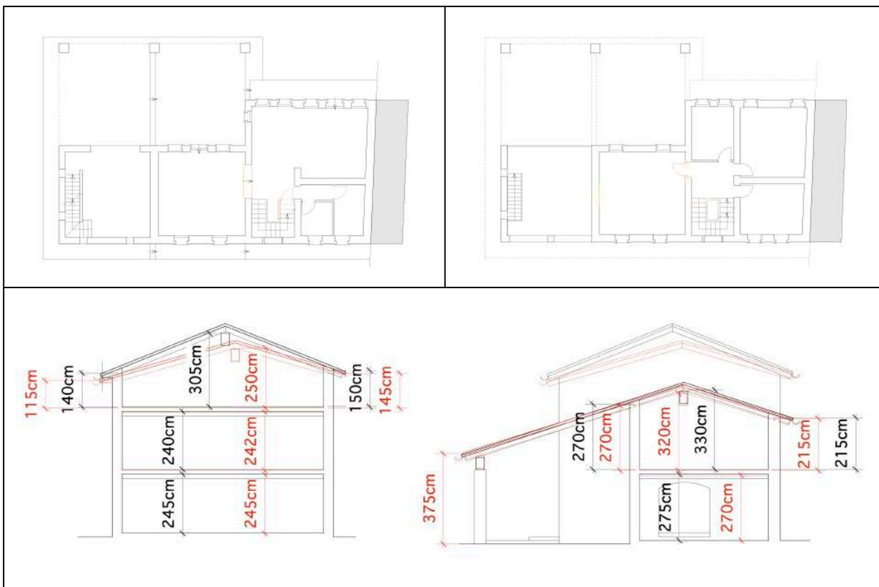
Principali difformità a piano terra, primo e in sezione (disegno non in scala).
