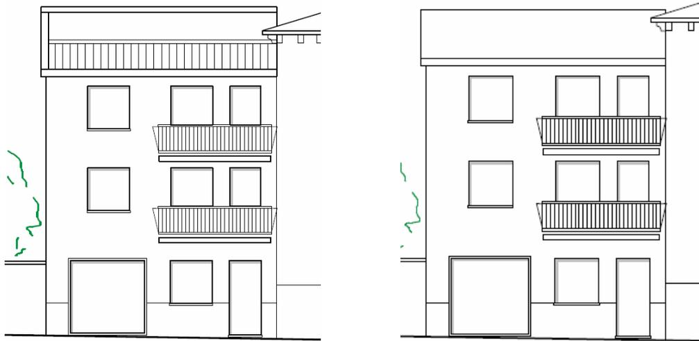
**Figura 39. Estratto tav. 06 e 07 del PdR (prospetto attua e di progetto).**
