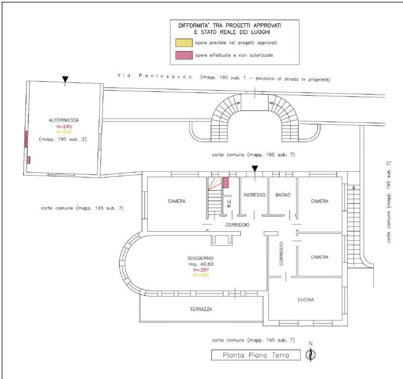
Figura 9. Comparazione stato attuale – stato rilevato.
