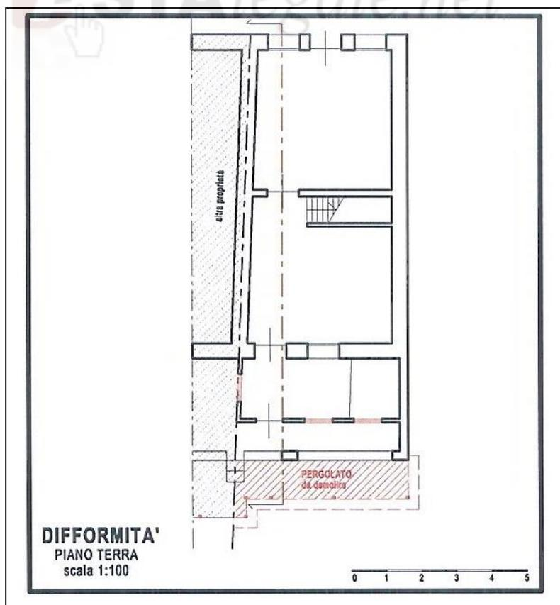
**Difformità: realizzazione tettoia, apertura finestre su tamponamento portico e modifica del materiale costruttivo ( il tamponamento era previsto in vetro)**
