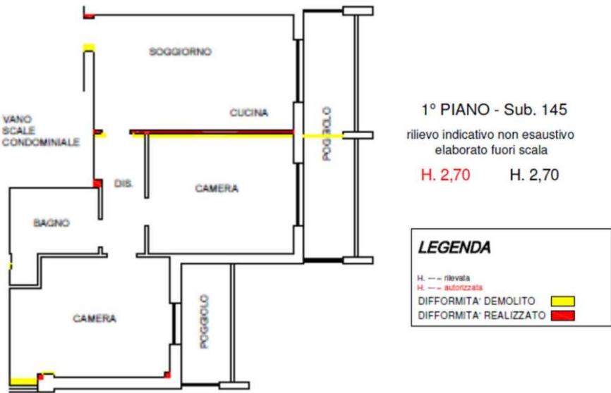
Figura 9.a Comparazione stato attuale – stato rilevato abitazione sub. 145.
