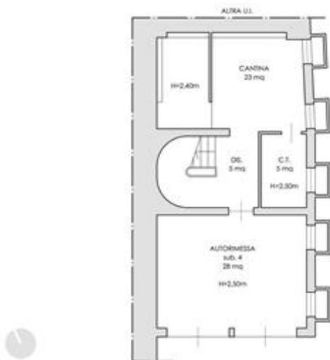
Schema distributivo dello stato di fatto - piano interrato.
