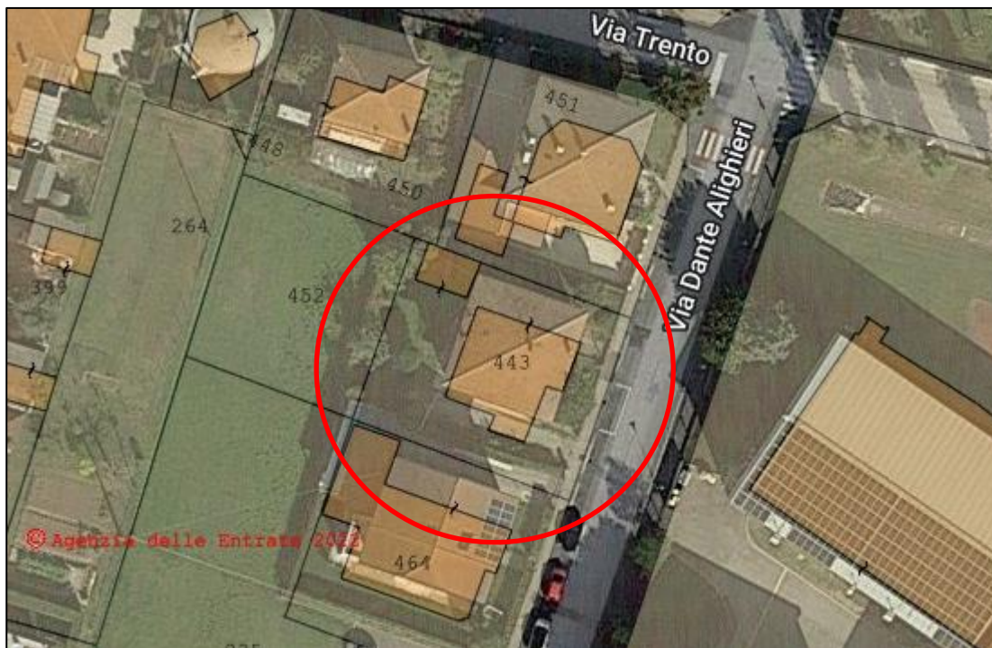
Sovrapposizione tra mappa catastale e ortofoto aerea, elaborata con Topoprogram.
