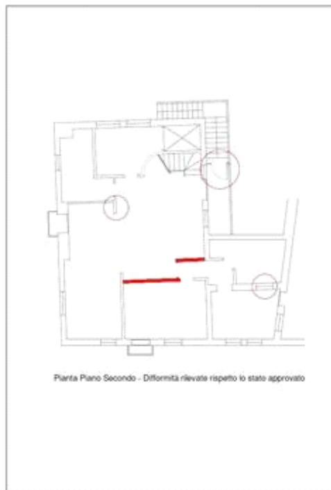
Rilievo stato attuale e difformità interne
